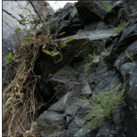
Figura 5-9: Gnaiss fraturado e à esquerda é possível observar uma parede lisa.
